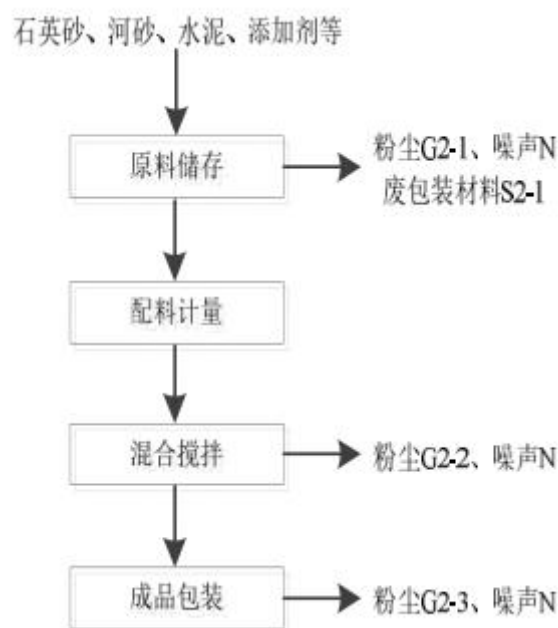
图 2-3 砂浆生产工艺流程图
